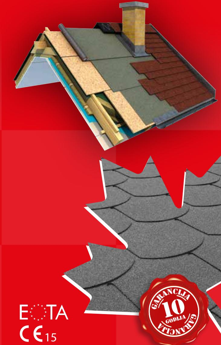
Bitumenska šindra TORONTO sa ojačanjem od staklenog voala ima ispušu od oksidiranog bitumena. Sa gornje strane ima oblogu od drobljenog škriljca a sa donje strane samolepljivi sloj (4-x-2) sa tankim zaštitnim slojem od PE folije. Dostupna je u dva oblika: biber i pravougaoni.
